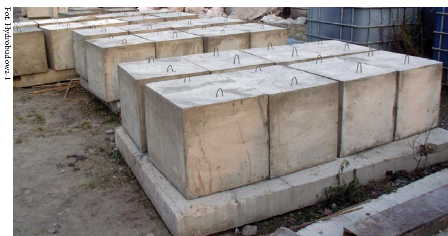
↑ Fot. 2. Rozformowane po 16 godzinach elementy na umocnienie brzegów rzek (transportowane na budowę po 20 godzinach). Zastosowano tutaj domieszkę do betonu Zimobet-334 produkcji P.I.W. Lubanta S.A.
