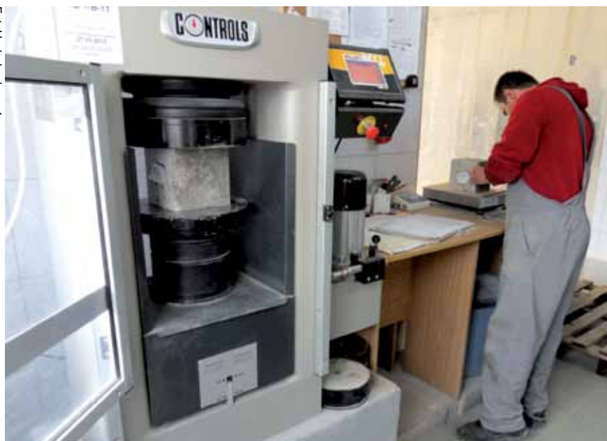
Fot. 2. Stanowisko badania wytrzymałości na ściskanie próbek betonowych
