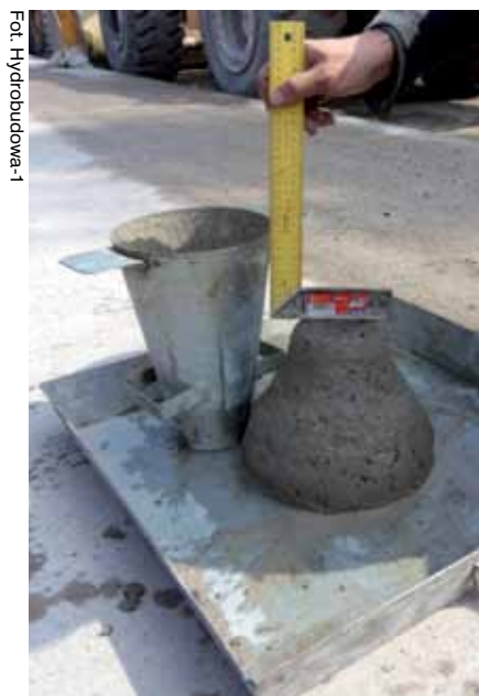
Fot. 1. Oznaczenie konsystencji mieszanki betonowej metodą opadu stożka
